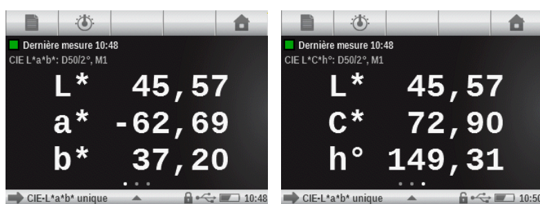
Figure 5 Pages mesure colorimétrique absolue ; valeurs colorimétriques en coordonnées L^*a^*b^* (à gauche), valeurs colorimétriques en coordonnées L^*c^*h^* (à droite)
