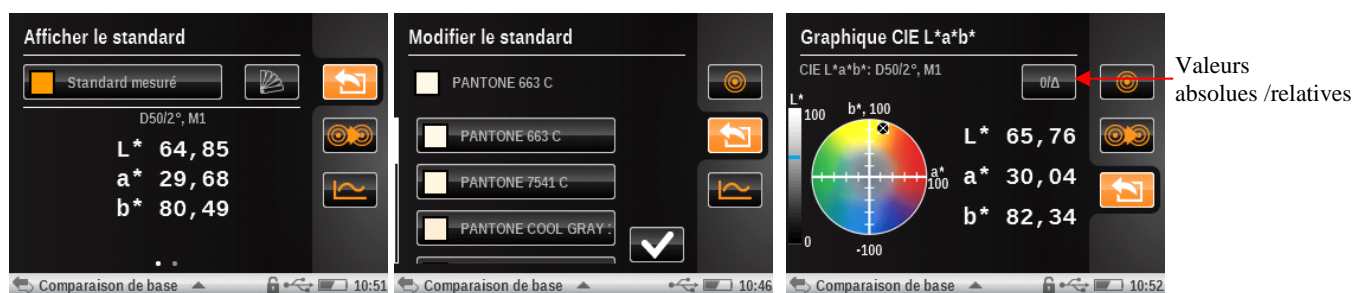
Figure 8 Pages secondaires du menu Comparaison de base ; valeurs colorimétriques du standard (à gauche), définition de la nuance Pantone la plus proche du standard (au centre), visualisations graphiques relative et absolue
