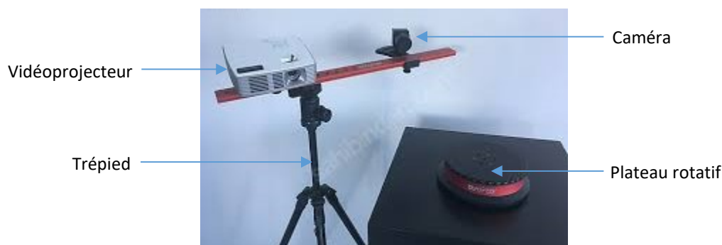
Figure 1 Présentation du scanner 3D David SLS-2
