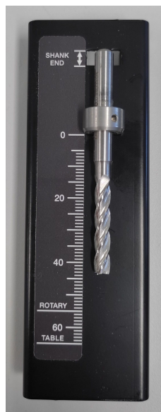
Figure 10 Dispositif de montage de l'outil pour la fraiseuse Roland MDX-50
