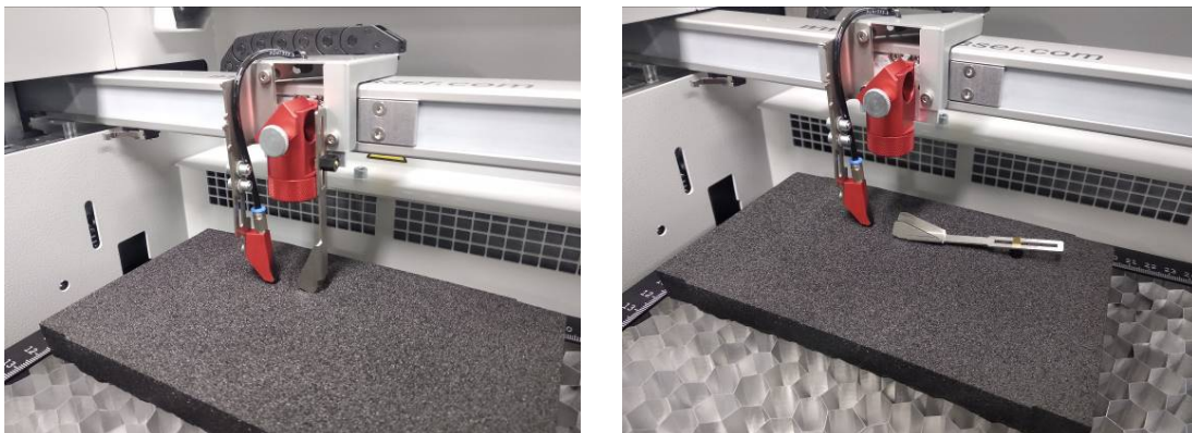
Figure 3 Réglage de la hauteur du plateau à l'aide de la pige
