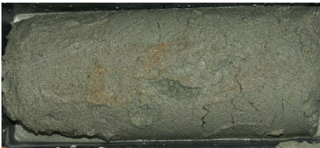
sables argileux verdâtres
